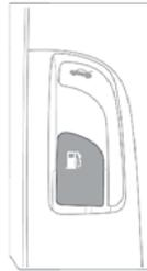
*NOTA: Después de agregar combustible, siempre vuelva a instalar la tapa de abastecimiento de combustible y asegúrese de hacer un mínimo de 3 a 5 clics. Si no lo realiza puede causar que se encienda la luz de indicación Verificación de Motor.*
