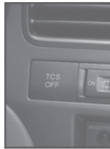
Sistema de Control de Tracción (TCS) Interruptor en el tablero del vehículo
