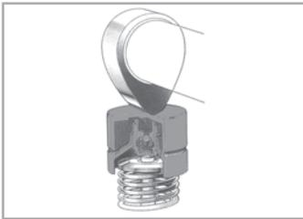
**HYDRAULIC VALVE LIFTER (LASH ADJUSTER)**
